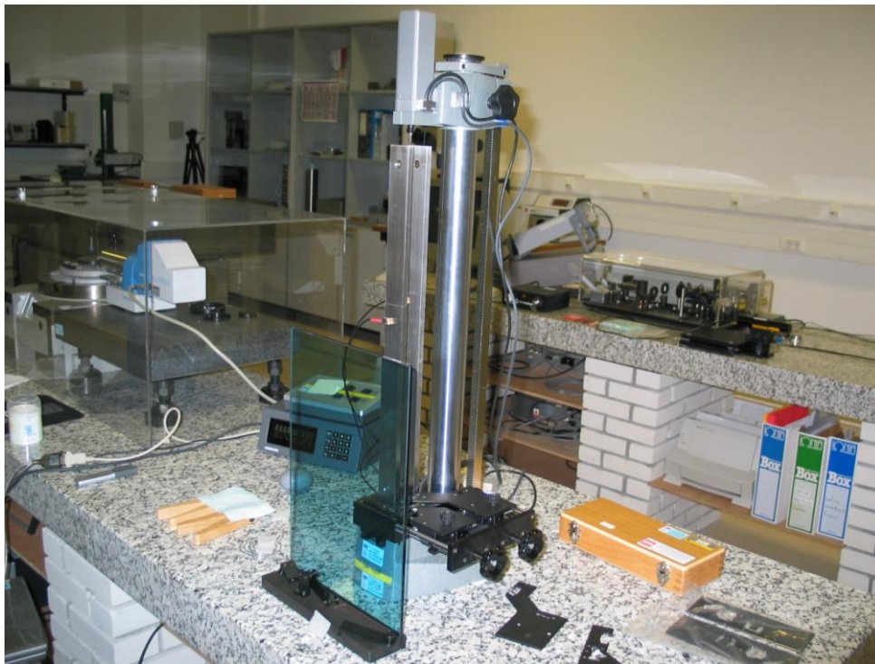
Σχήμα 2. TESA UPD, μηχανικός συγκριτής πλακιδίων σε κάθετη διάταξη. Ο συγκριτής έχει την δυνατότητα μέτρησης πλακιδίων σε κάθετη διάταξη με ονομαστικό μήκος από 0 μέχρι 500 mm.
